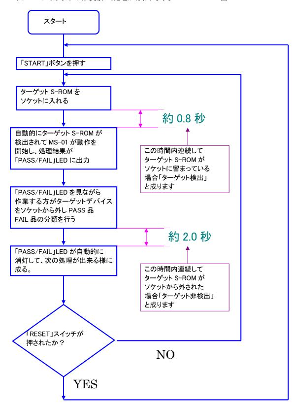
前頁の「Auto-Start 1図」以外の使用方法としては、ソケットにターゲット S-ROM を実装したままで「START」スイッチを押す手法が有ります。
