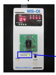
6 自動的に IC を検知して 動作を開始。終了後、 「Pass/Fail」表示されます
