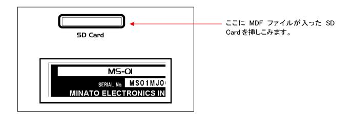
Step 4: 正しい MDF ファイルが検出されると自動的に SD Card の内容が本体にバッファメモリ及びパターン発生器に転送されます。
