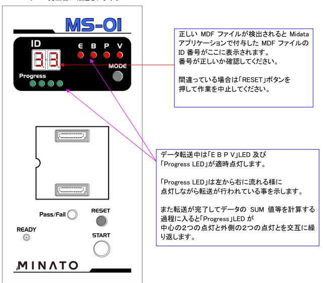
Step 5: 本体のバッファメモリ及びパターン発生器へのデータ転送が終了する。
