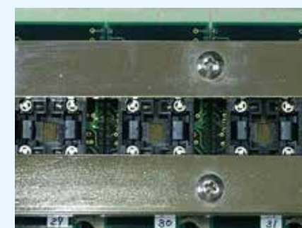
ソケットが開いている時(押さえユニット下降時)
