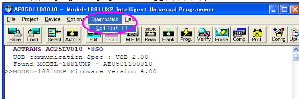
※ 下記のように【Self Test F7】が選択できない場合は一度、【Select】よりデバイス選択を行って下さい。デバイス選択を行うことで【Self Test F7】が選択できるようになります。
